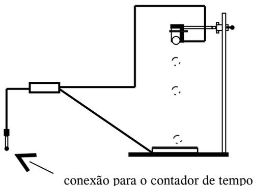
Figura 1 – Representação esquemática da montagem para o experimento de queda livre.
